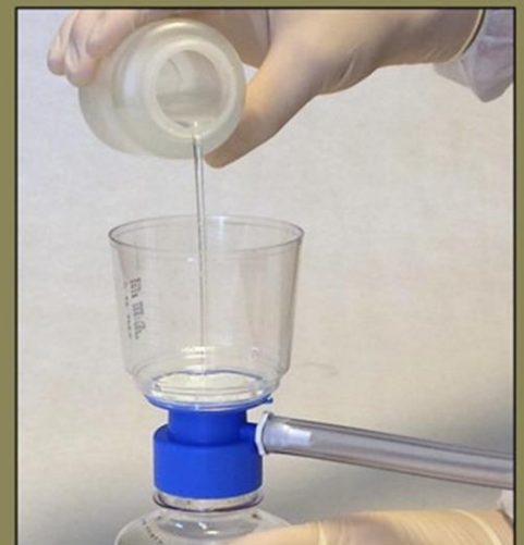
Après avoir récupéré l'ADN sur la surface d'intérêt, versez la solution tampon recueillie à travers le filtre, scellez le filtre et envoyez-le au laboratoire pour analyse.
